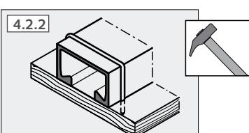
**4.2.2** Fijación de perfiles HALFEN 28/15 a 52/34 mediante grapas: Clavar el perfil HALFEN al encofrado de madera con una cantidad suficiente de grapas.
