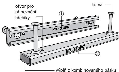
Profile HALFEN jsou dodávány s výplní z kombinovaného pásku a jsou opatřeny otvory na upevnění hřebíky. Přesahující výplň seřízněte.
