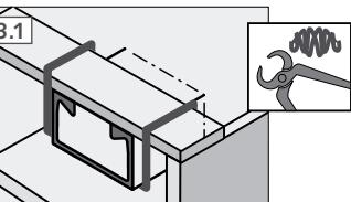
**4.3 Befestigung mit Hilfskonstruktion**
