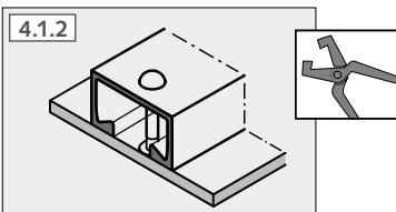
**4.1.2** Fijación usando remaches de aluminio colocados en los taladros del perfil HALFEN.
