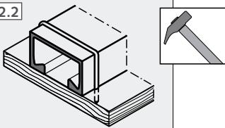
**4.2.2** Befestigung Halfenschienen 28/15 bis 52/34 mit Heftkrampen:
