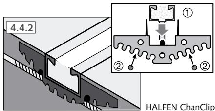
**4.4.2** Colocación sobre la armadura superior usando la grapa de plástico HALFEN
