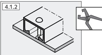
**4.1.2** Halfenrail met aluminium popnagels door de spijkergaten aan de bekisting vastzetten.
