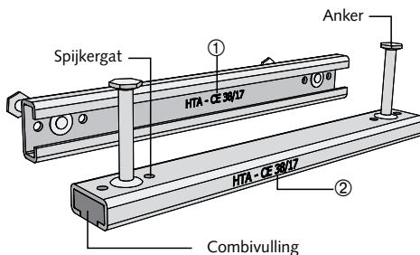
Halfenrails zijn gebruiksklaar en voorzien van combivulling en spijkergaten. Eventueel uitstekende combivulling gelijk met het raileinde afsnijden.
