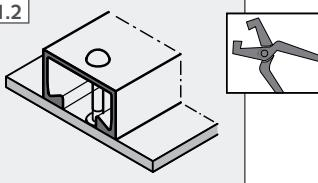
**4.1.2** Halfenschiene mit Alu-Popnieten (bauseits) durch die Nagellöcher an der Schalung fixieren.
