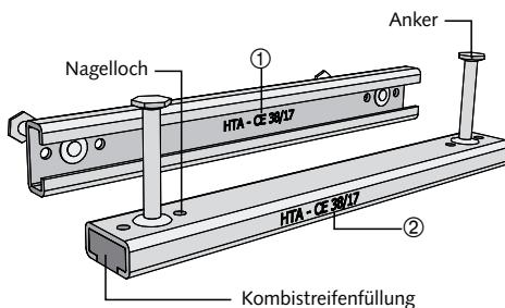
Halfenschienen sind verlegefertig mit Kombistreifenfüllung und Nagellöchern ausgestattet. Eine ggf. überstehende Kombistreifenfüllung ist bündig abzuschneiden.
