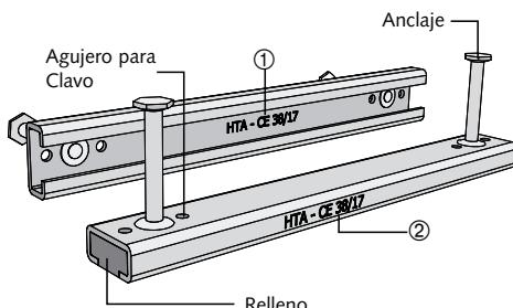
Los perfiles HALFEN se suministran con un relleno de espuma y con agujeros para clavar al encofrado. El exceso de relleno debería cortarse en los bordes del perfil. Antes de fijar al encofrado asegurarse del tipo de perfil HALFEN (perfil, material, longitud) así como su posición en los planos. Fijar los perfiles de forma segura para que no puedan moverse durante el proceso de hormigonado. Si el encofrado no fuera adecuado para clavar por favor seleccionar un método de fijación alternativo.
